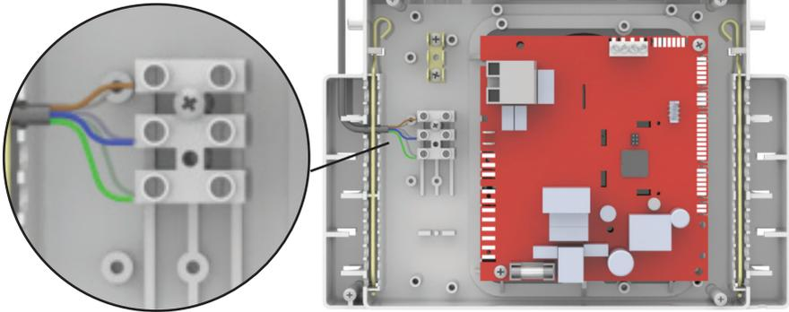
Per le connessioni o la sostituzione di conduttori utilizzare cavo di classe H05VV -F, H05VVH2-F CEI EN 60228) o superiori.
